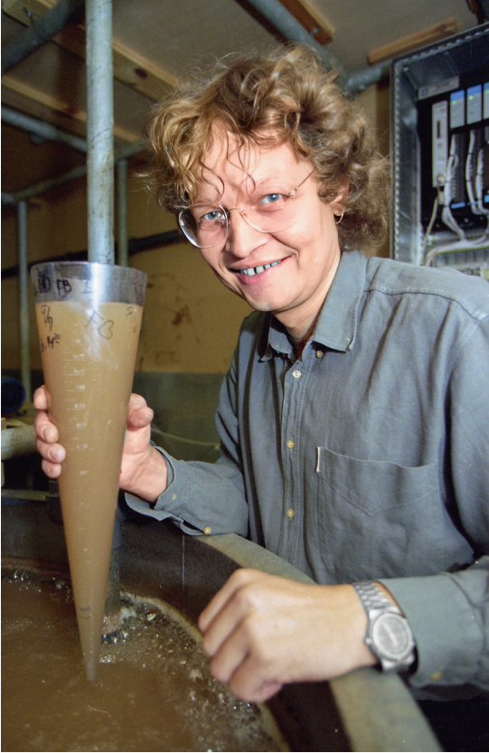
Anders Lynggaard, afdelingschef i VKI, tjekker bundfældigheden af slammet i VKI's pilot-spildevandsrens anlæg. 1996. Foto Preben Hupfeld (i Aarhus Stadsarkiv).
